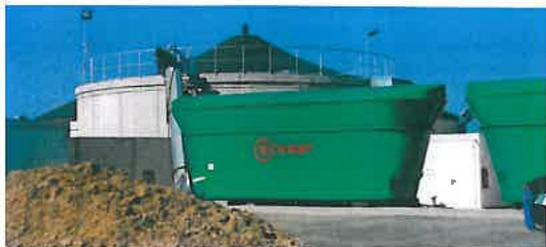
Zur Beschickung von Biogasfermentern bietet Eckart Feststoffdosierer mit stehender Mischschnecke an.
